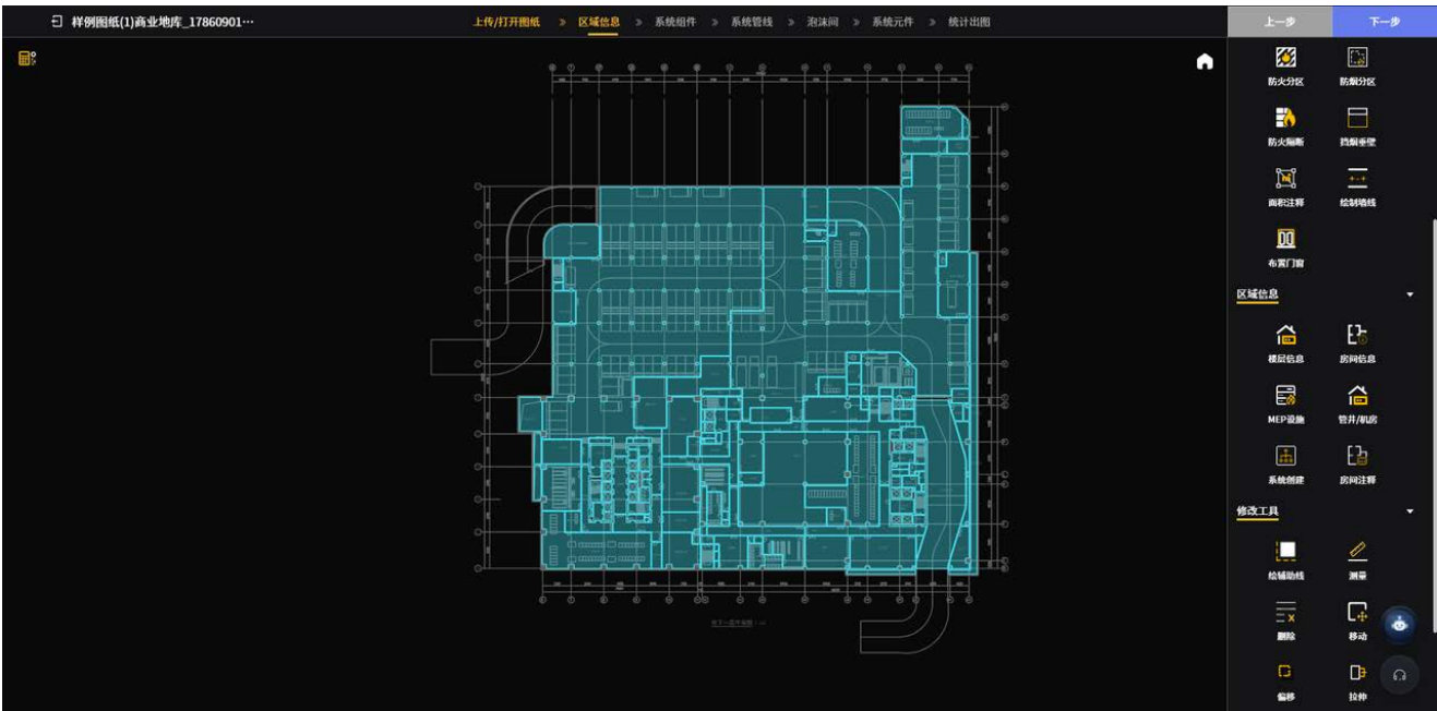
图2：一张图纸上传后自动识别图纸然后进行区域分区的结果
